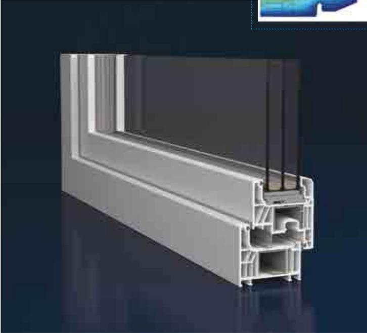
Legend Sistemi, 80 mm oturma genişliğine göre, 6 odalı olarak tasarlanmıştır. Sistemin tasarımında özellikle yüksek performans kriterleri göz önünde bulundurularak, profiller en uygun yapı taşlarının bir araya getirilmesi ile oluşturulmuştur. Tasarım süreci, profilin yanı sıra, pencere performansı olarak, yalıtım (ısı ve ses), mukavemet, sızdırmazlık özellikleri bütünsel olarak değerlendirilmiştir. Sistemdeki profiller, TS5358-EN12608 standardına uygun olarak üretilmektedir.
